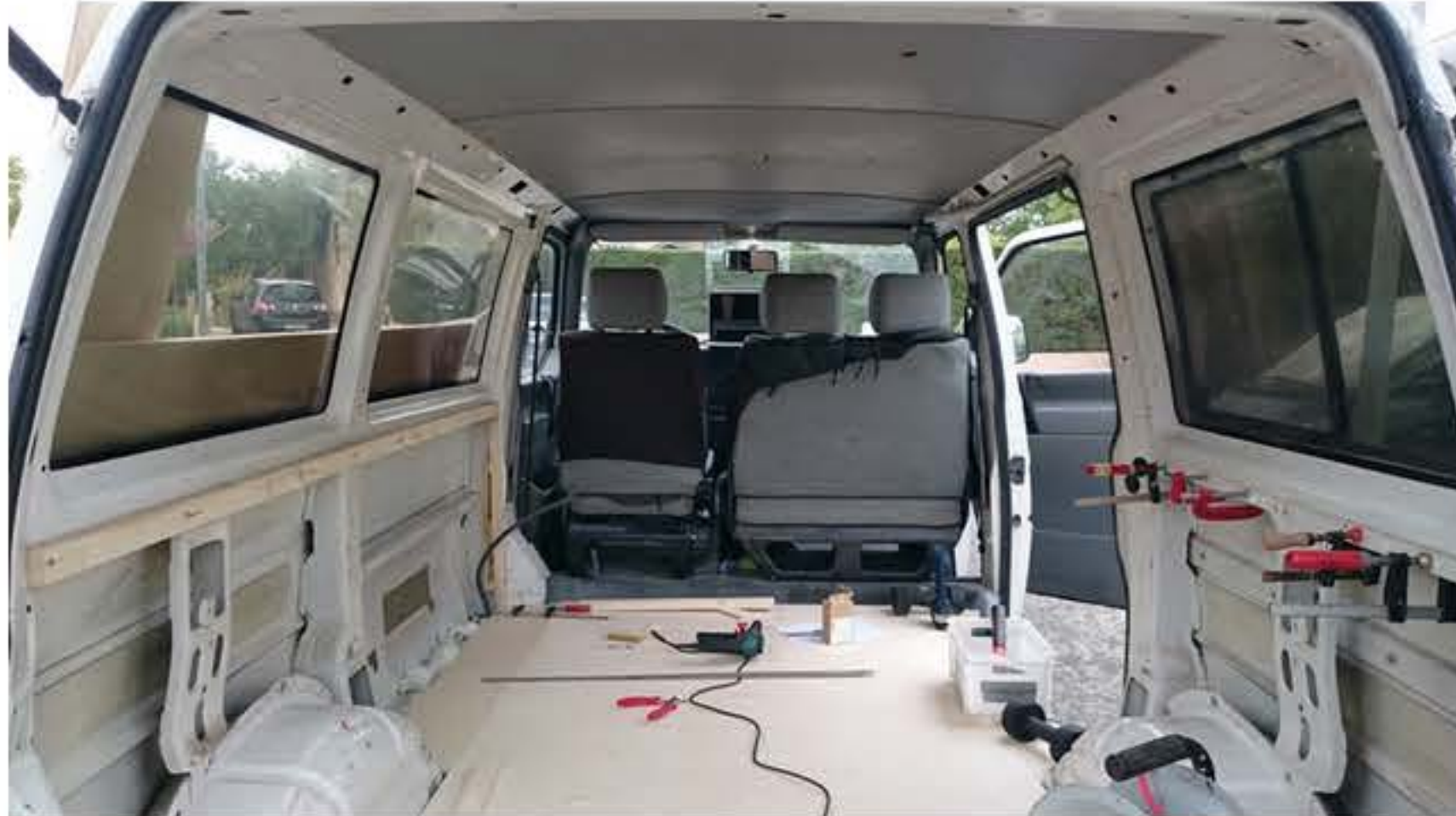
Le tasseau du haut fait 226 cm. Des cales permettent de rattraper la courbe de la carrosserie.
