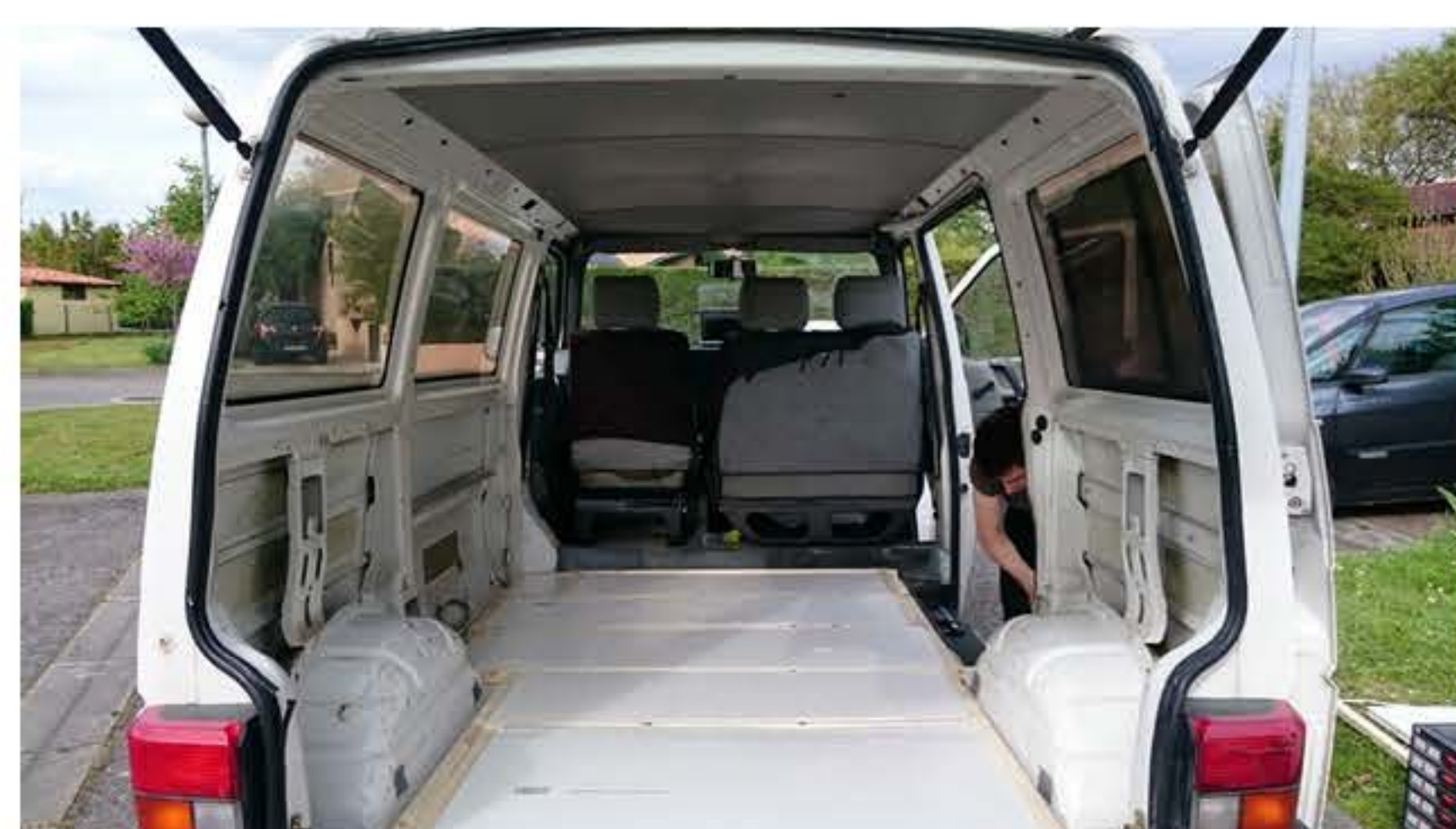
Mise en place rapide du polystyrène extrudé
