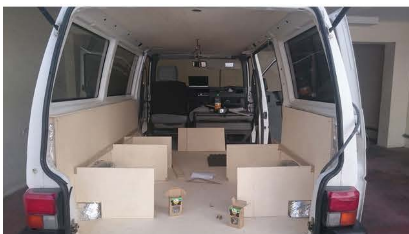
Les refends côté cuisine ont une découpe supplémentaire pour les passages de roue.
