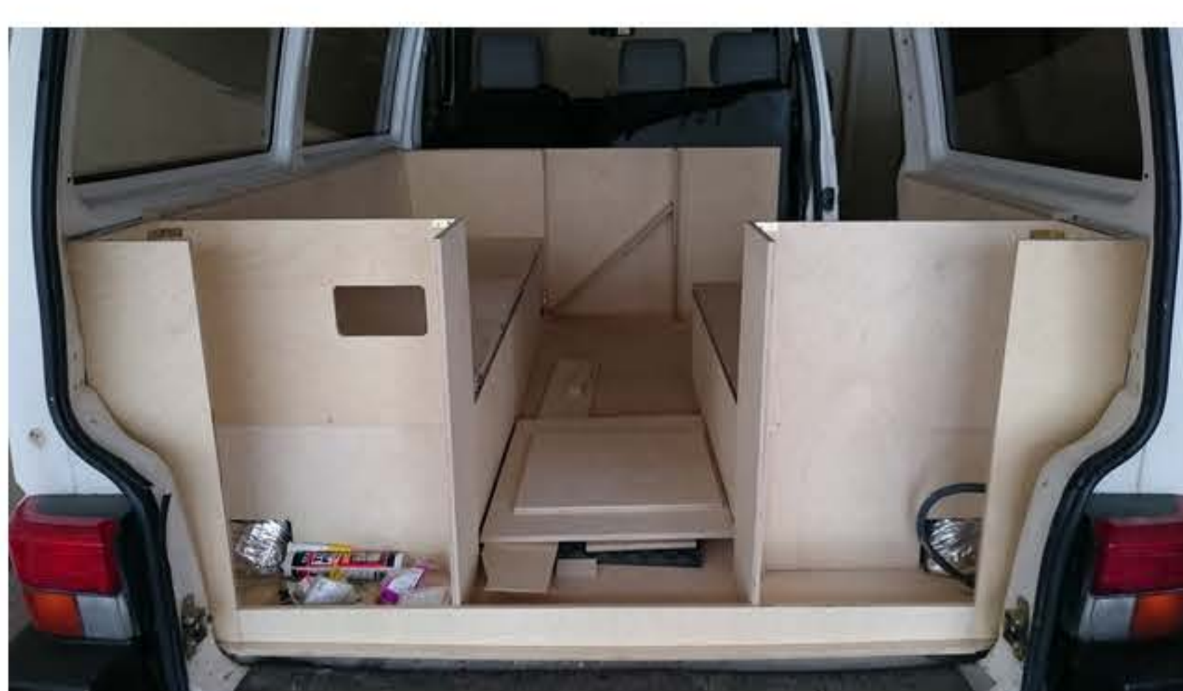
Le trou découpé à gauche servira à aménager une trappe pour accéder au gaz depuis l'extérieur.
