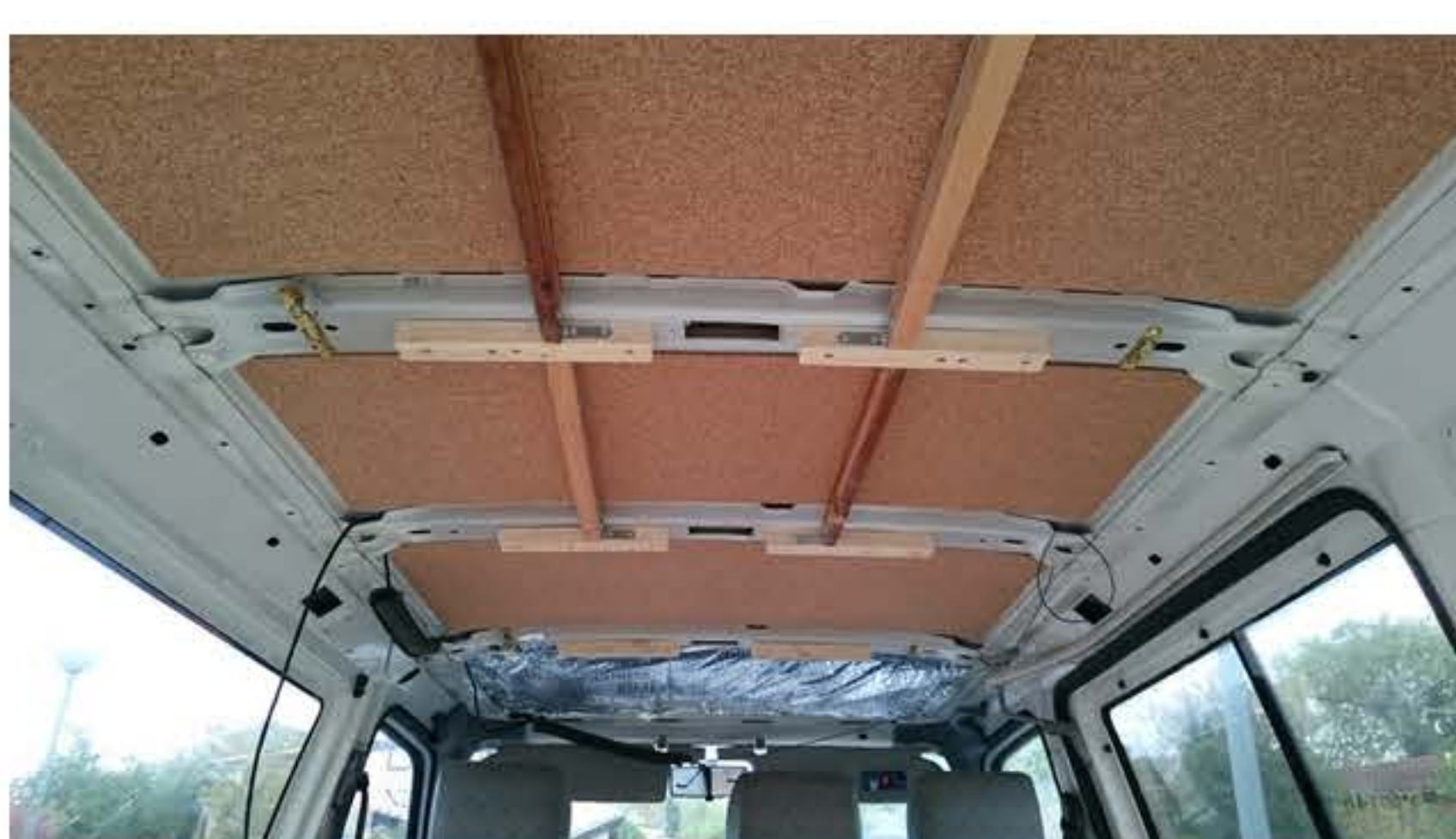
Les tasseaux dans la longueur sont maintenus avec des équerres vissées sur les premiers tasseaux.
