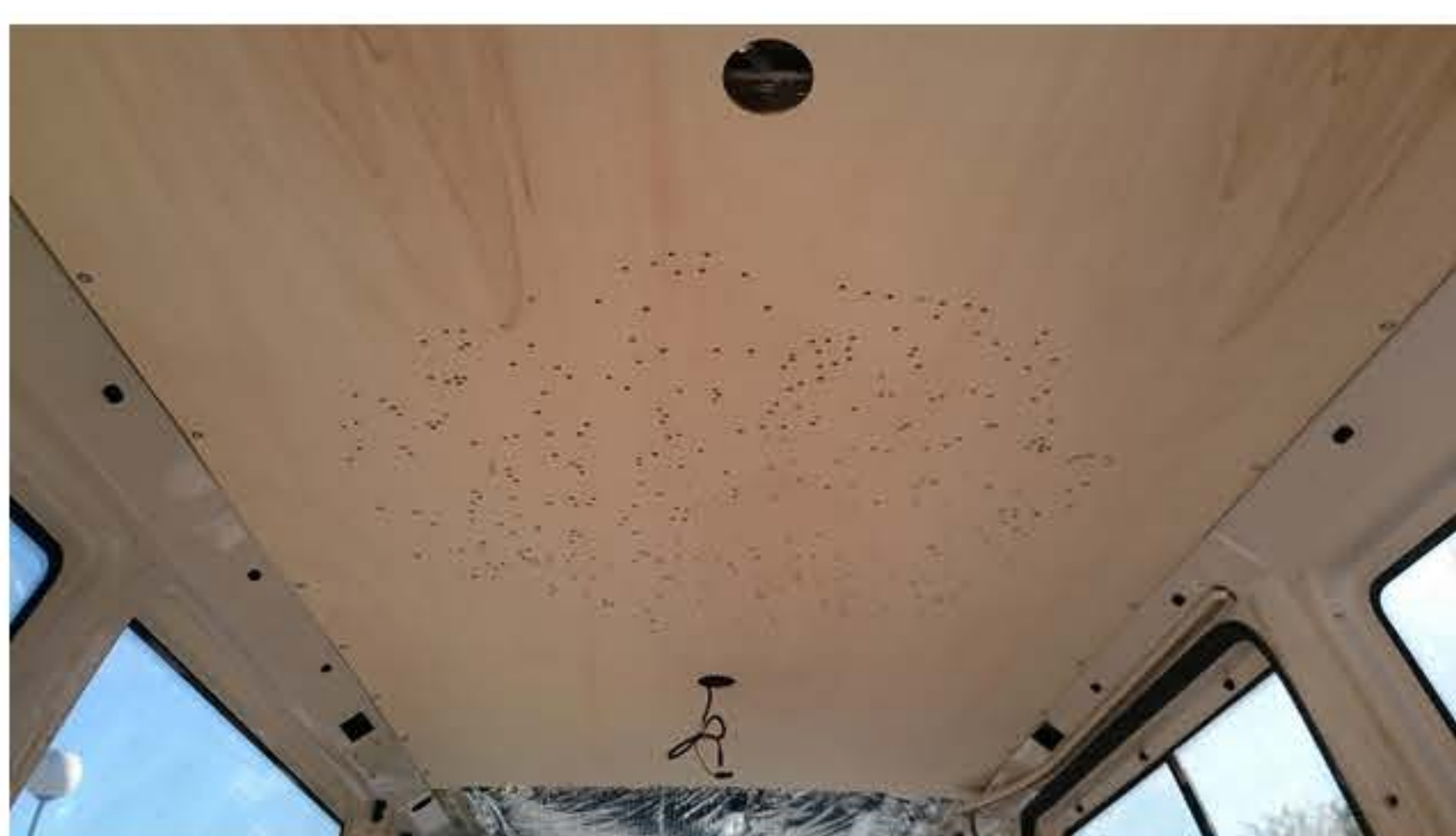
La première plaque de peuplier avec les réserves pour les spots.
