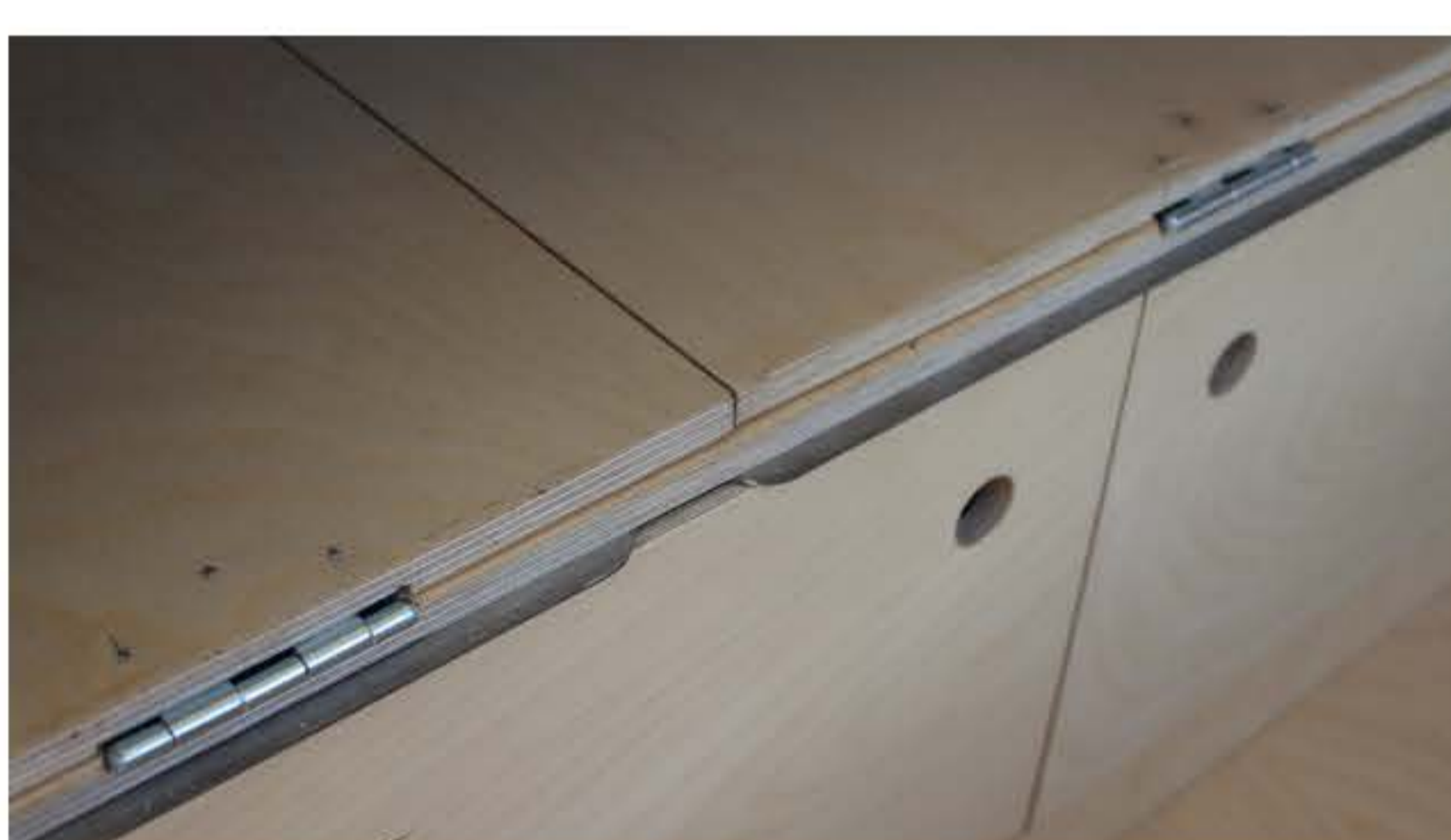
Les fer-plat côté charnières. Il y a deux morceaux car plus pratique à visser ainsi.
