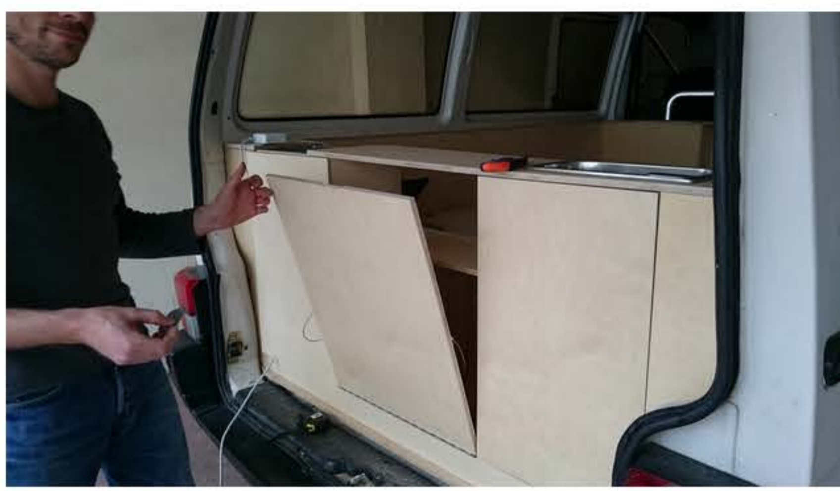
L'élément central pivotant sur une charnière piano.
