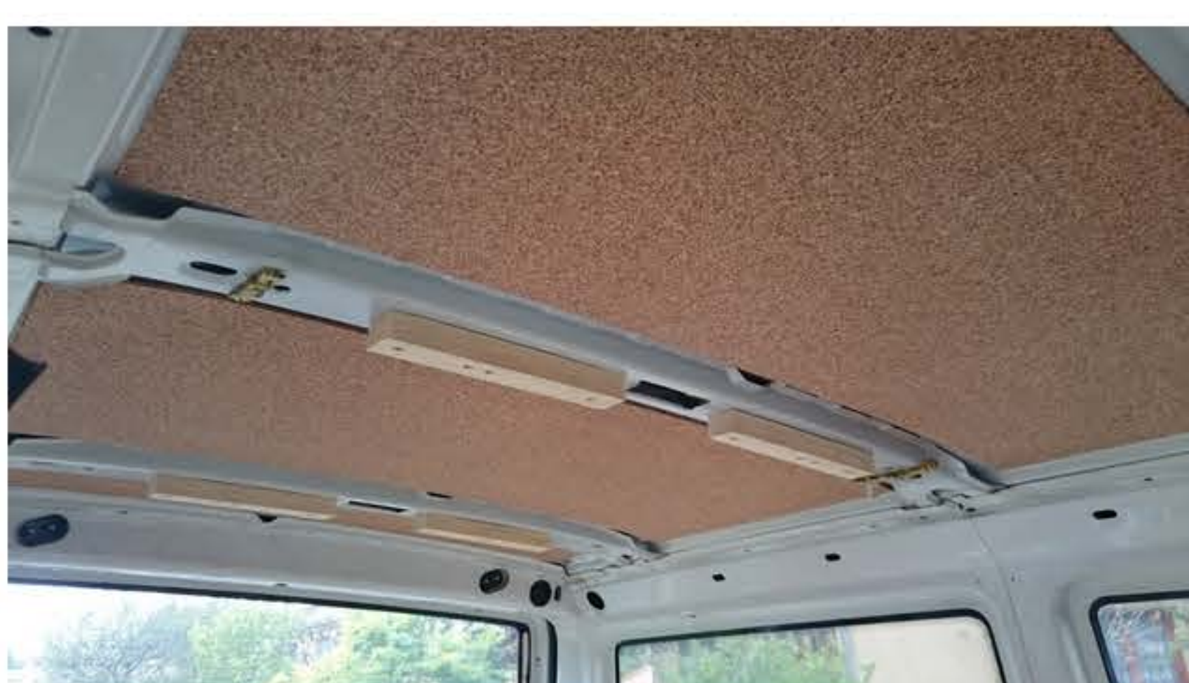
Les tasseaux dans la largeur prennent la carrosserie en sandwich.
